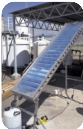
Le système fonctionne à circuit fermé : les eaux de rinçage des pulvérisateurs sont progressivement "nettoyées" en descendant en cascades sur le papier supportant le photocatalyseur (TiO 2 ). Au bout de quelques heures, les eaux sont à ce point purifiées que l'on peut les réutiliser.
